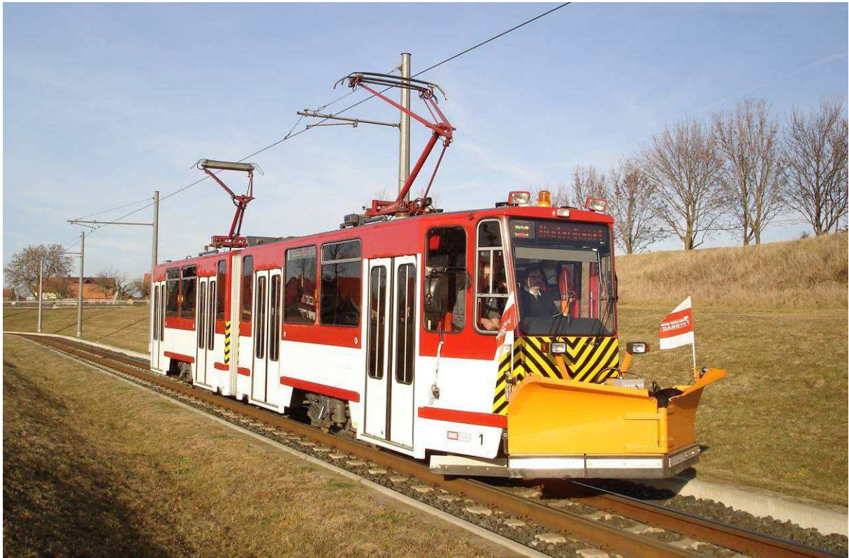
Erfurt: Triebwagen 1 ex 430 als Winterdienstfahrzeug.
