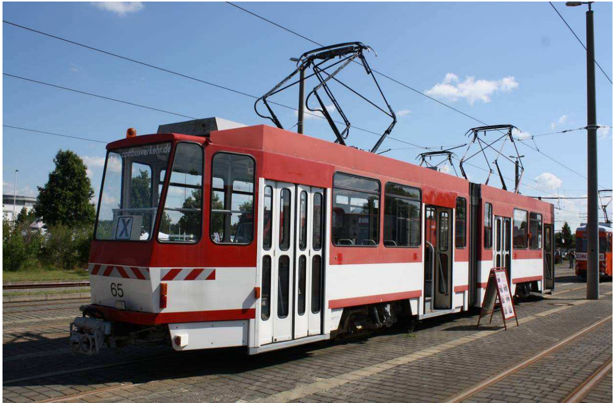
Cottbus, Arbeitswagen 65 mit Einrichtung zum Besprühen der Oberleitung mit Frostschutzmitteln. Foto: Ivo Köhler
