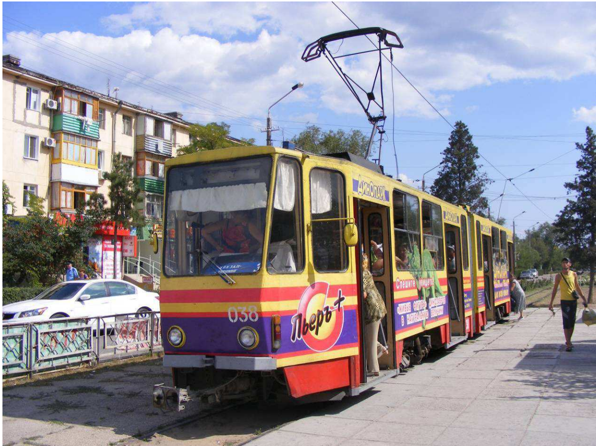
Jewpatoria: Zum Zweirichtungswagen umgebauter Triebwagen 038 Foto: Robert Leichsenring
