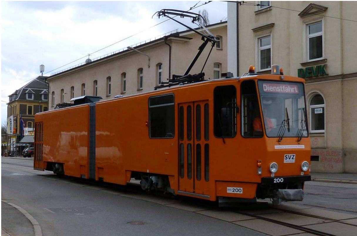
Zwickau: Schienenschleifwagen 200 (ex Plauen 230)
