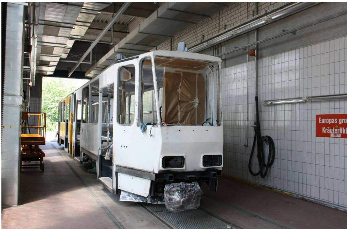
Gera: Derzeit erhält ein Teil der Geraer KT4DM letztmalig eine gründliche Instandsetzung, hier Wagen 307 im Juli 2010. Foto: Ivo Köhler
