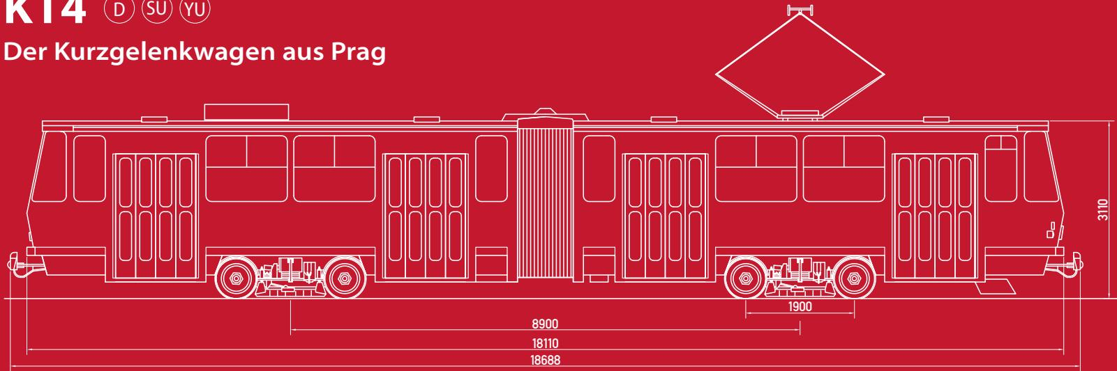
Zwischen 1975 und 1997 baute der tschechische Schienenfahrzeughersteller ČKD Prag insgesamt 1750 Straßenbahntriebwagen des Typs KT4. Die Firma lieferte diese Fahrzeuge an Verkehrsbetriebe in damals drei Staaten: in die DDR, in die Sowjetunion und nach Jugoslawien. Durch Verkäufe von Gebrauchtfahrzeugen und die Änderungen staatlicher Strukturen findet man diese Bahn heute in 12 europäischen und asiatischen Ländern in insgesamt 34 Betrieben.
